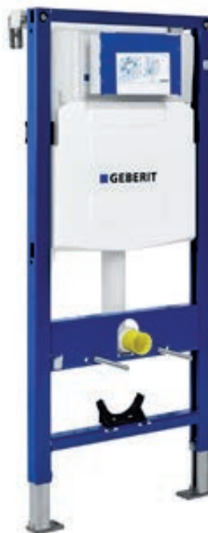
Geberit Duofix WC-element m. Sigma reservoir 12cm (UP320) H112cm | z. bedieningsplaat | 111308005 | artikel 0700090
